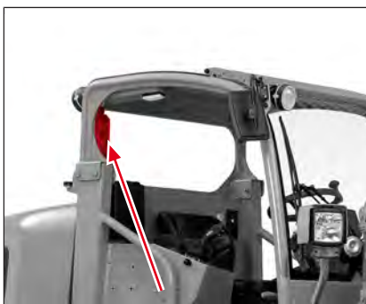
III. 3: Monteringssted til brandslukkeren
